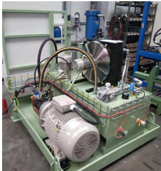
Zkoušky hydraulického agregátu na zkušebně
